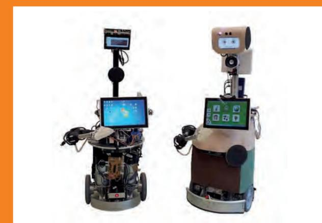
TUビエンナにおけるサービスロボット開発プロジェクト"HOBBIT"。自律ロボットに使用されています。
