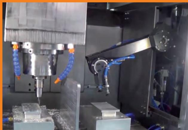
ロボリンクDCを使用したフライス加工
