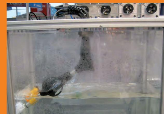
4軸アームを使用し、水中でカメラを移動させる装置 [ イグス社内製 ]
