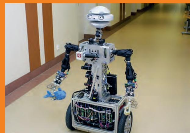
ブロクワフ(ポーランド)工科大学にて、自律ロボットの腕部に2つの4軸可動ロボリンクを使用。
