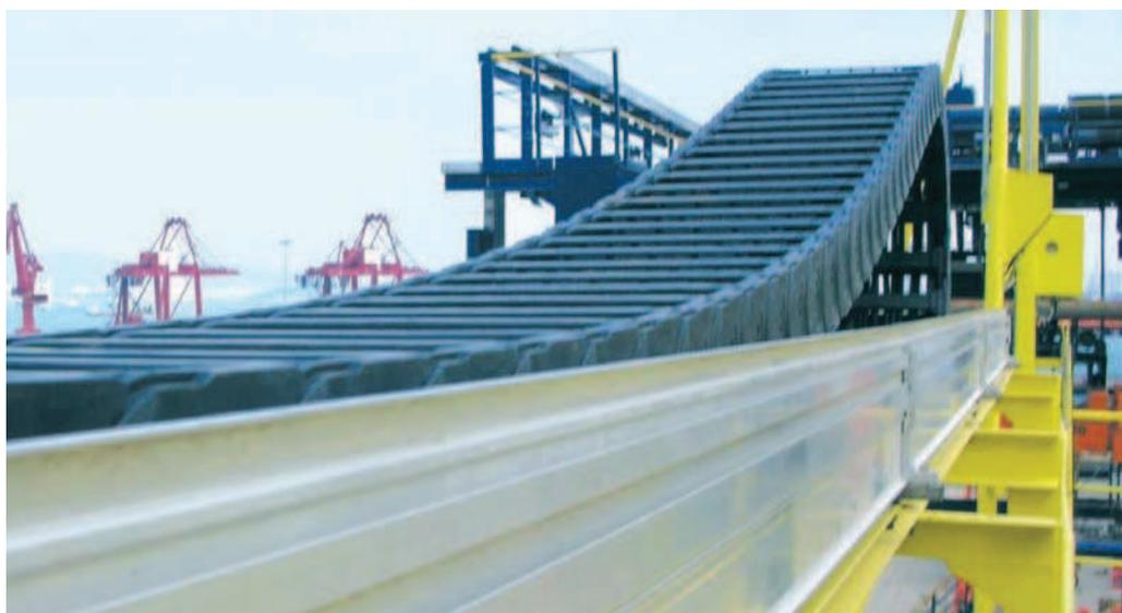
RTG-クレーンでの海水耐性のアルミ製ガイドチャンネル。イグスE4シリーズでの長い走行
